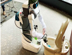
（写真左）遠隔操作によるロボットでのトイレ清掃の公開実験の様子。操作をAIが学習することにより同じ条件下では自動モードでの動作をも可能にする
